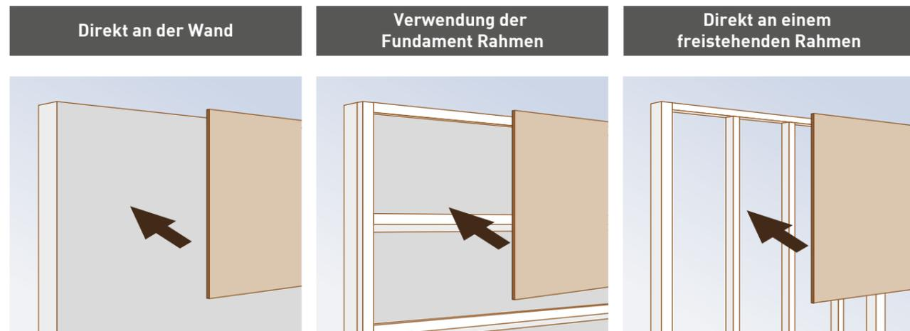
Diese Montageart bietet sich bei einer glatten und ebenmäßigen Oberfläche an.      Diese Montageart bietet sich an, wenn die Oberfläche nicht ebenmäßig ist.      Diese Montageart ist nützlich, wenn Sie diese an einem freistehenden Rahmen befestigen möchten.
