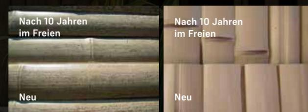
EVER BAMBOO® Paneele bestehen mit speziell verstärktem ASA-Harz aus einem recycelbaren Rohmaterial, das die Umwelt schont. Durch diesen speziellen Werkstoff ist es widerstandsfähig gegen Regen, Sonnenlicht, Korrosion und Verfärbungen und hat eine nachweisbar lange Lebensdauer.
